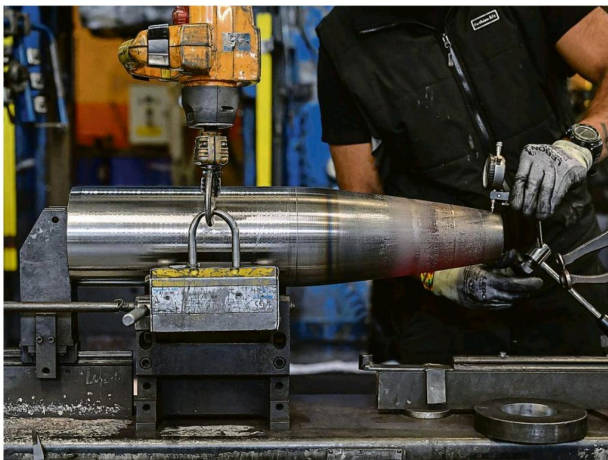
Usinage d'un obus de 155 mm aux Forges de Tarbes, dans les Hautes-Pyrénées. Photo Ed Jones/AFP
