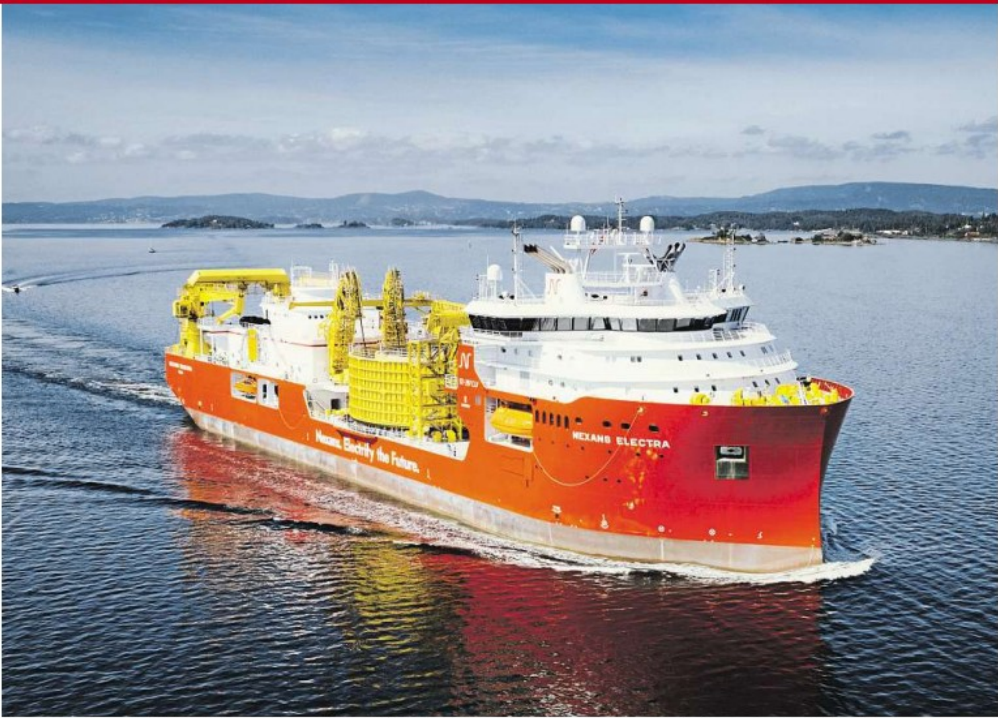
Nexans a investi 300 millions d'euros dans l'Electra. À la pointe de la technologie, le navire de 150 mètres de longueur et de 35 mètres de large peut embarquer 13 500 tonnes de câbles.
