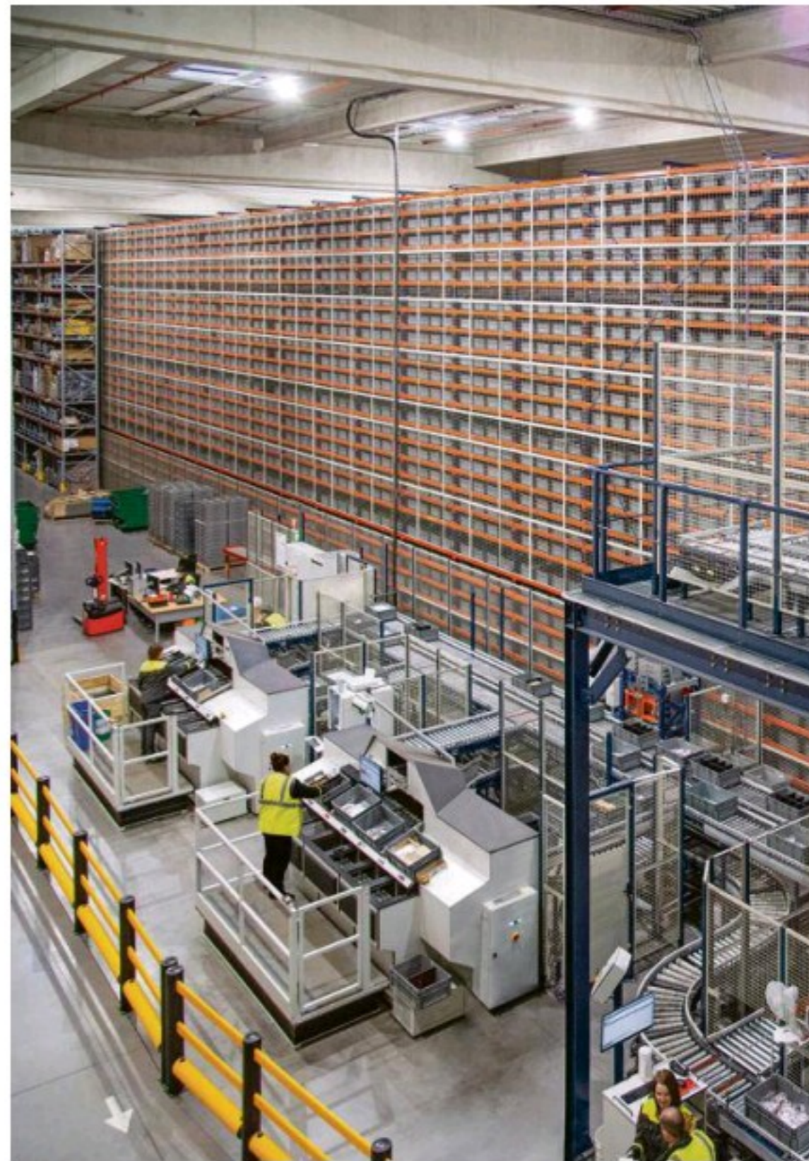
Mecalux propose deux dispositifs qui servent au stockage et aux préparations de commandes de bacs de produits, ainsi qu'au transport et au stockage de palettes. Photo Manitou Groupe/Mecalux
