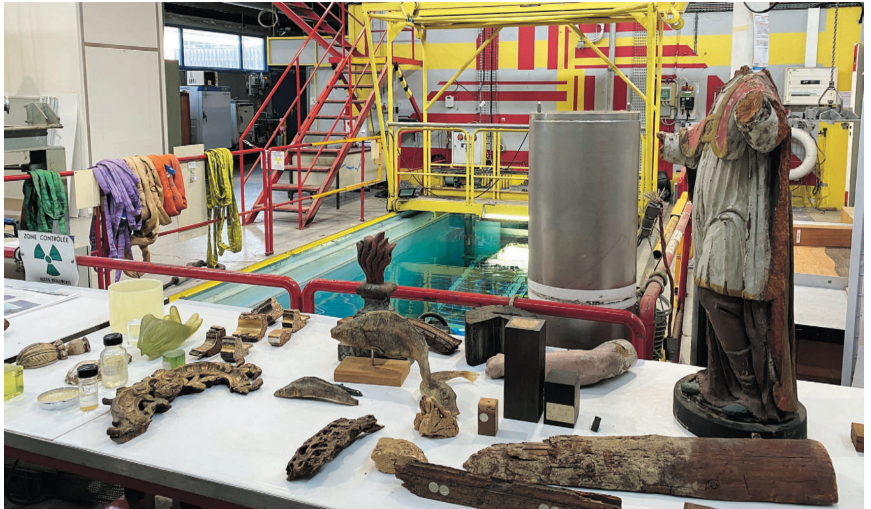
Au sein du laboratoire ARC-Nucléart, des sources radioactives, protégées dans un bassin rempli d'eau, permettent d'irradier des objets de plusieurs siècles, éradiquant bactéries, insectes et champignons. SANDY PLAS
