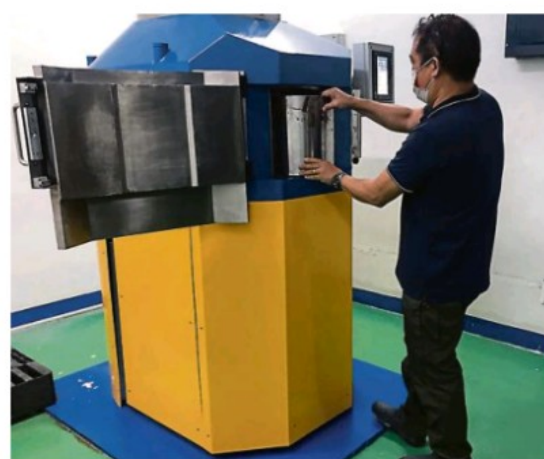
La structure moléculaire des déchets est modifiée grâce aux radiations. Photo Nutec
