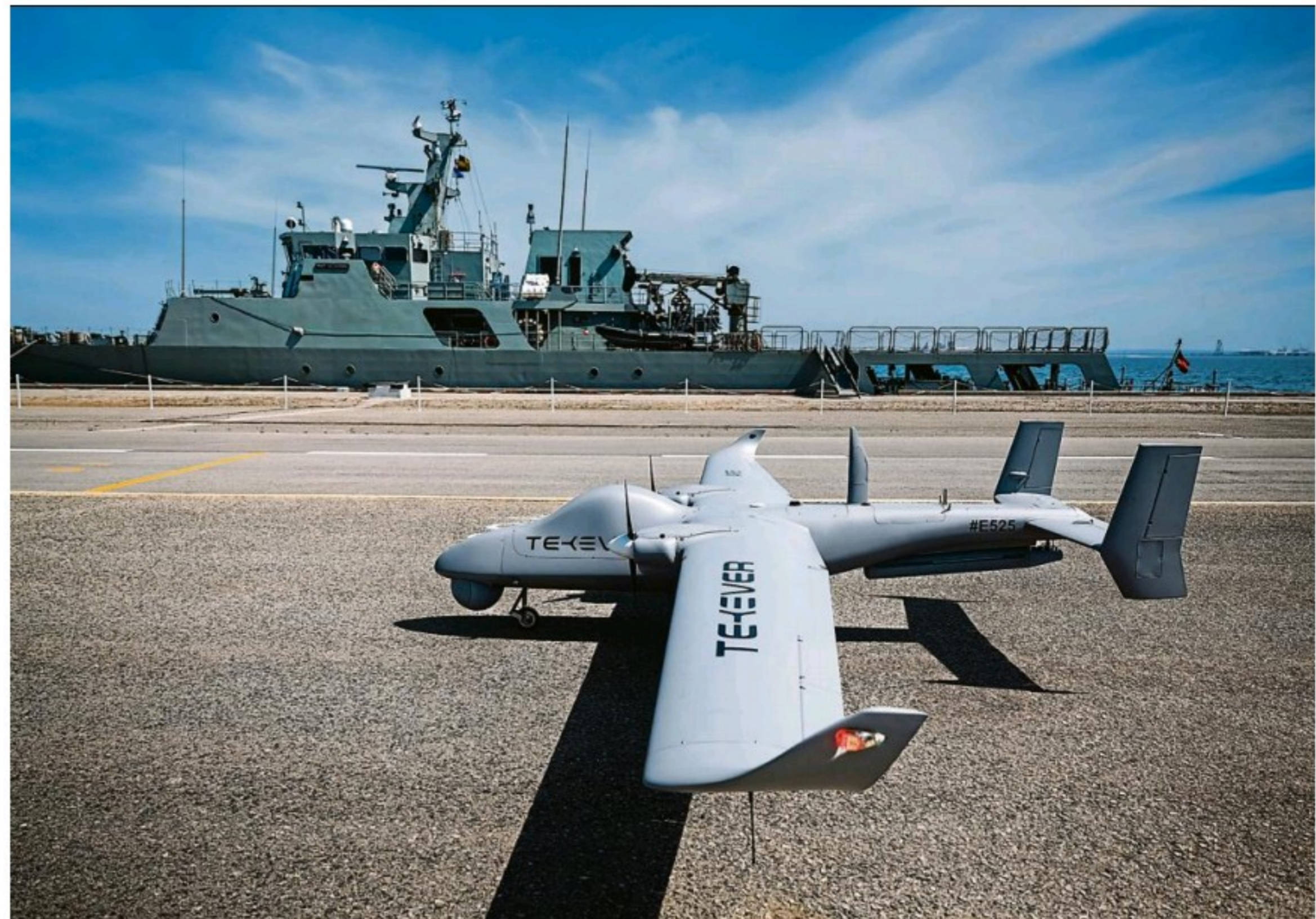
L'AR5 à voilure fixe, de Tekever (en photo), de 7 mètres d'envergure et moteur thermique, peut parcourir 700 kilomètres et porter 50 kg.
